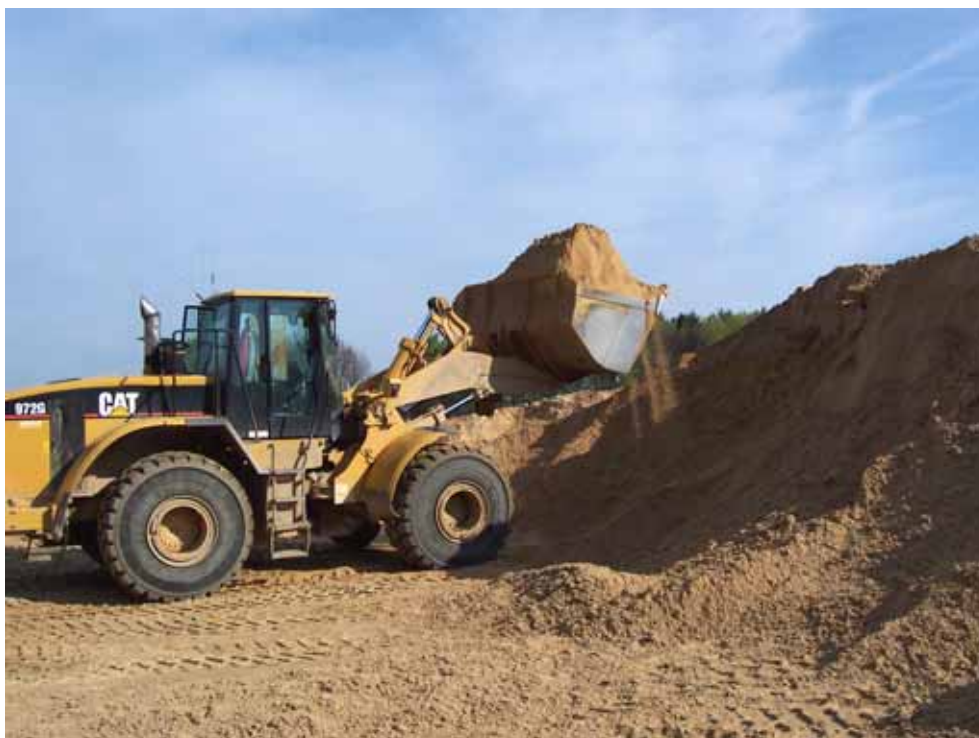
Abb. 5: Rohstoffgewinnung mittels Radlader im Trockenschnitt
